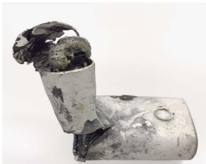
▲過度な力が加わり発熱・発火した加熱式タバコ
